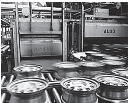
Алюминиевая промышленность: печь отпуска колес
